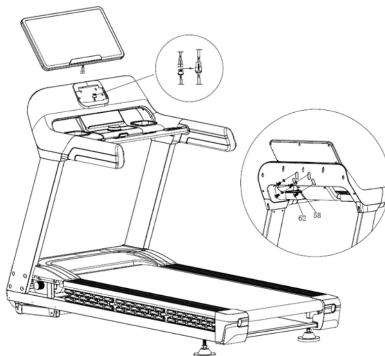
**Schritt 4:** Verwenden Sie die mitgelieferten M4,2\*16-Schrauben (48), um die Abdeckung der Frontstützen (36L/R) fest an den Frontstützen zu befestigen. Stecken Sie den Sicherheitsschlüssel (rot) in die Mitte der Konsole. Jetzt können Sie das Laufband benutzen.
