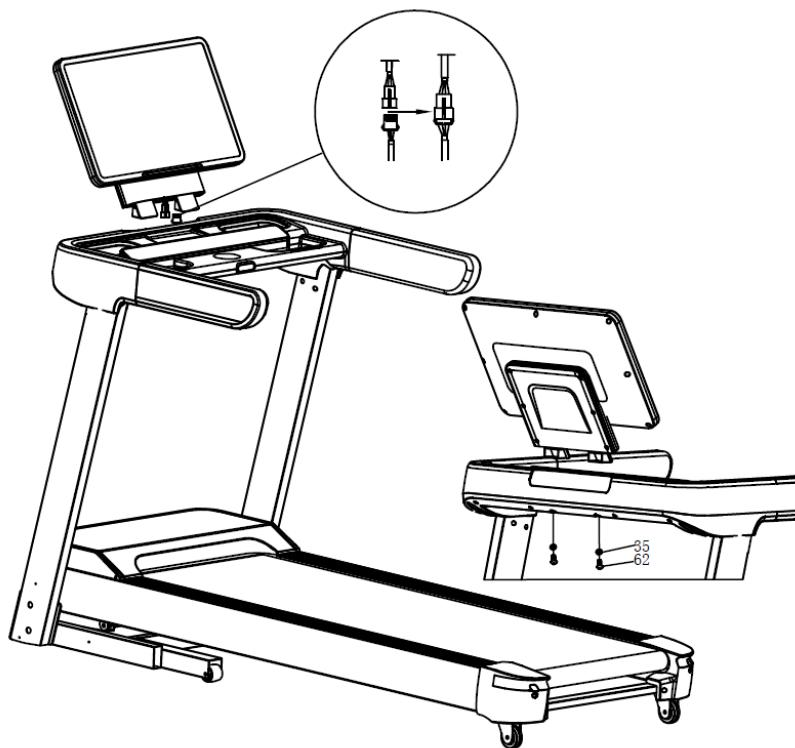
**Schritt 4:** Verwenden Sie die mitgelieferten M4,2\*16-Schrauben (3), um die Frontstützenabdeckung (59L/R) fest auf den Frontstützen (16L/R) zu befestigen.
