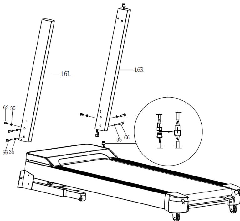
**SCHRITT 2:** Verbinden Sie die Kabel zwischen der Konsole und der rechten Frontstütze (16R). Nun befestigen Sie die Konsole mit den mitgelieferten M10\*20-Schrauben (62) und Unterlegscheiben (35) an den Frontstützen.
