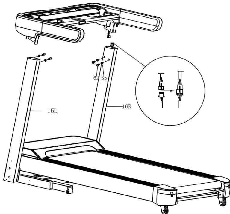
**SCHRITT 3:** Verbinden Sie die Kabel zwischen dem Display und der Konsole. Verwenden Sie danach die Schrauben M10x20 (Nr. 62) und die Unterlegscheiben (35), um das obere Messgerät an der Konsolenplatte zu befestigen.
