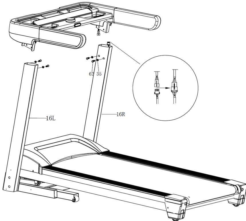
**SCHRITT 3:** Verbinden Sie die Kabel zwischen dem Display und dem Armaturenbrett. Verwenden Sie die mitgelieferten M10x20-Schrauben (62) und die flachen Unterlegscheiben (35), um das Display am Armaturenbrett zu befestigen.
