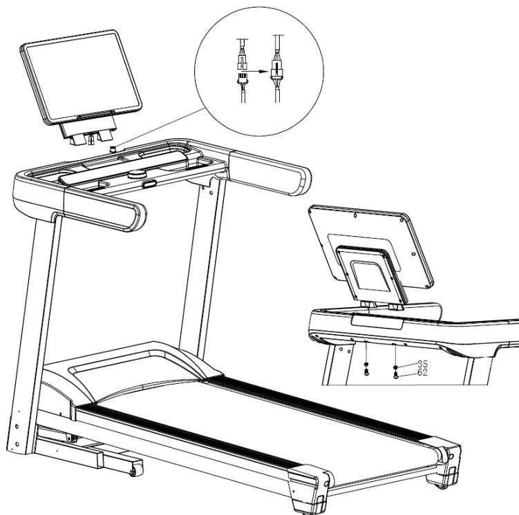
**Schritt 4:** Befestigen Sie die Abdeckung der Frontstützen (59L/R) mit den mitgelieferten Schrauben M4,2x16 (3) fest an den Frontstützen (16L/R).
