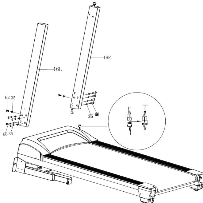
**SCHRITT 2:** Verbinden Sie die Kabel zwischen der Konsole und der rechten Frontstütze (16R). Verwenden Sie die mitgelieferten M10x20-Schrauben (62) und die flachen Unterlegscheiben (35), um die Konsole an den Frontstützen zu befestigen.
