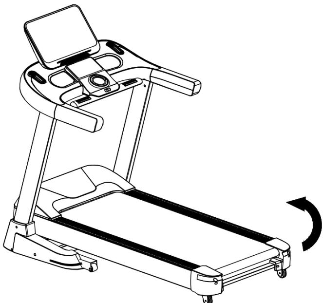
Heben Sie die Lauffläche an und ziehen Sie es mit Kraft nach oben, bis Sie ein "Klicken" hören und Sie spüren, dass der Sicherheitsmechanismus eingerastet ist.
