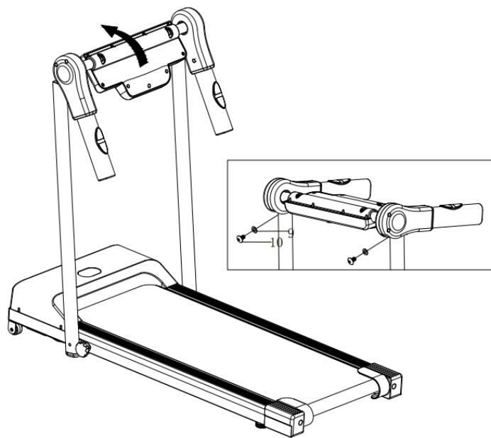
**SCHRITT 3:** Klappen Sie die Konsole hoch und befestigen diese mit den M8 Handrädern. Stecken Sie den Sicherheitsschlüssel (14) auf der Konsole an, jetzt können Sie die Maschine starten
