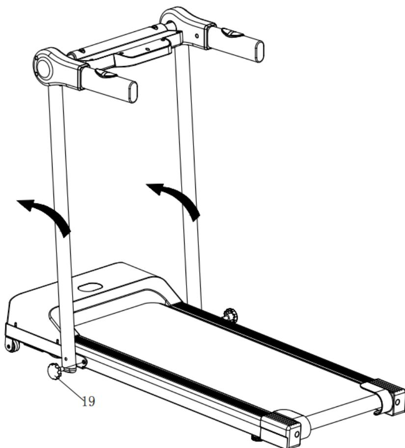
**SCHRITT 2:** Klappen Sie die Handgriffe hoch. Verwenden Sie die M8x16 Schrauben (10) und die Beilegscheiben (9), um die Handgriffe, wie auf dem Bild unterhalb beschrieben, an den Frontstützen zu befestigen
