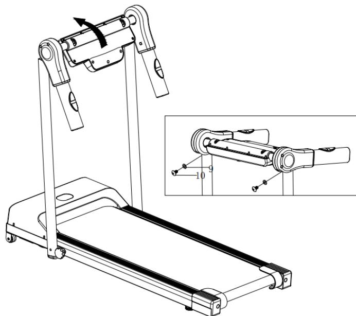
**FASE 3:** Ripiegare la console e fissarla con i volantini M8. Inserire la chiave di sicurezza (14) sulla console, ora è possibile avviare la macchina.
